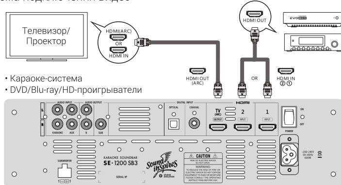
Подключите HDMI-выход караоке-системы Studio Evolution к HDMI 1 входу саундбара. Подключите HDMI-выход других устройств (например, сетевой приставки, DVD, проигрывателя Blu-ray) к входному интерфейсу HDMI 2 саундбара. Подключите выходной интерфейс TV Output (ARC) саундбара к HDMI-входу телевизора/проектора.
