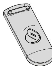
Поместите "ключ" в паз крышки батарейного отсека. Поверните заднюю крышку по часовой стрелке для того, чтобы закрыть, и поверните заднюю крышку против часовой стрелки для того, чтобы открыть.
